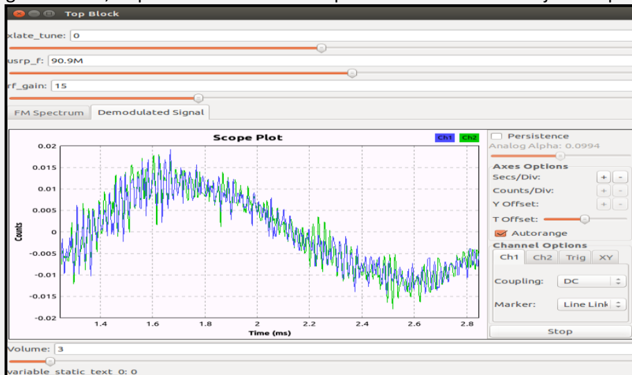
Figura 5 Señal recibida emisora comercial en frecuencia f = 90.9 \text{ MHz}
