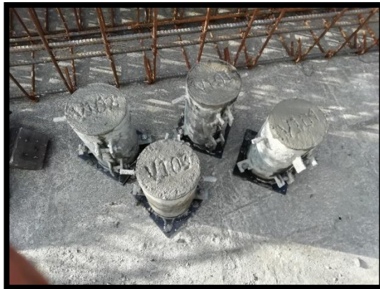
Imagen 37: Toma de muestras de concreto.
