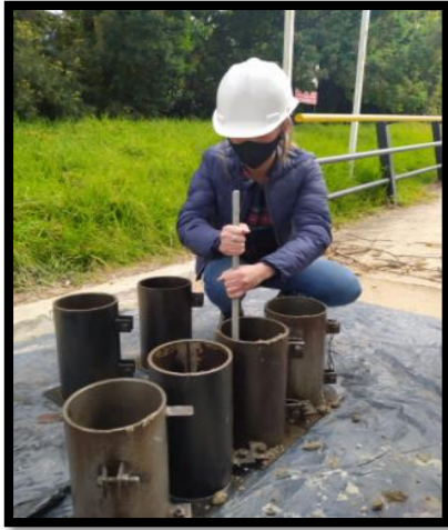
Figura 41. Elaboración cilindros de concreto.
