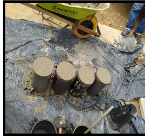
Figura 40. Elaboración cilindros de concreto.
