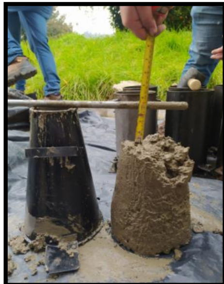
Figura 38. Toma de asentamiento.
