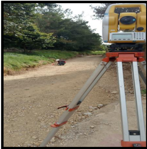
Figura 14. Nivelación y configuración estación total.
