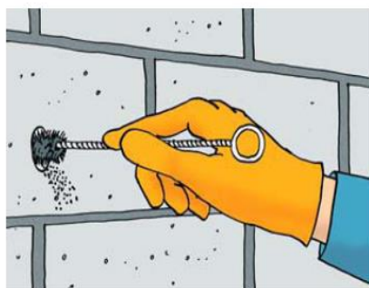
FIGURA B: LIMPIAR LA PERFORACIÓN DEL POLVO CON CEPILLO CHURRUSCO
