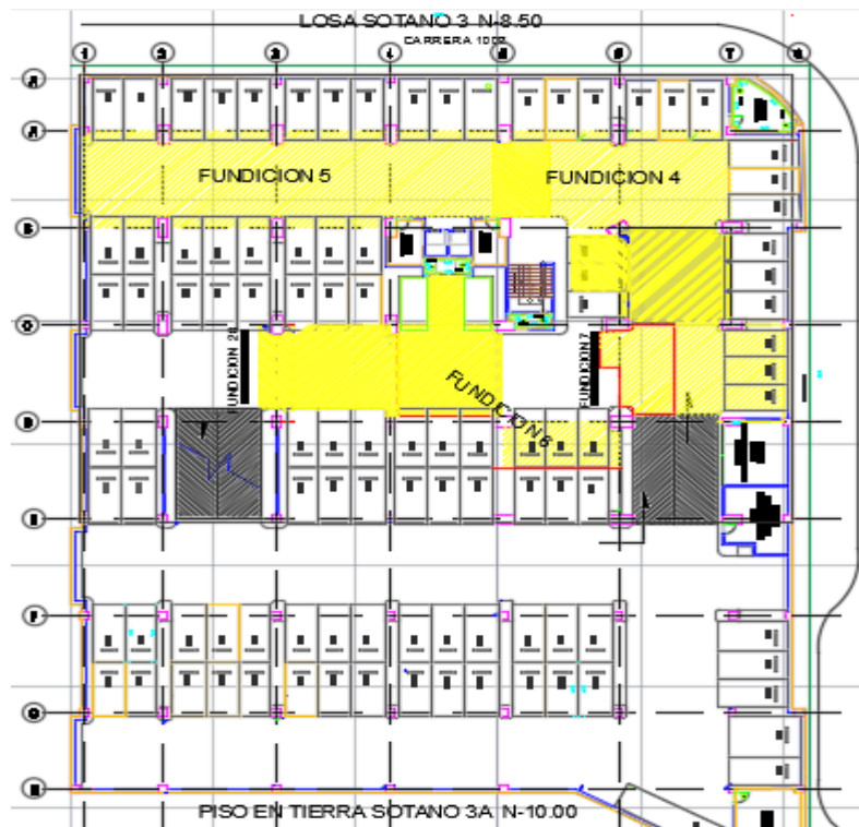
Fig. #105 Fundicion losetas N-850 y N-1000
