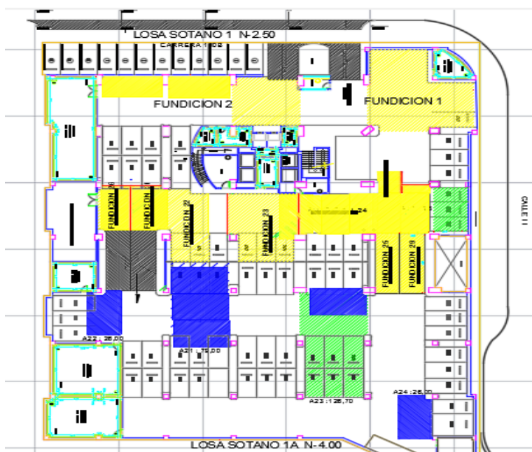
Fig. #103 Fundicion losetas N-250 y N-400
