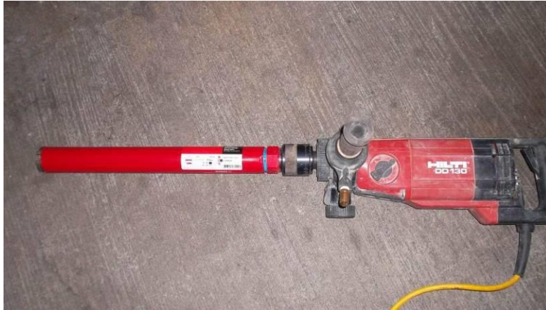
Fig. #57. Extractor de Núcleos
