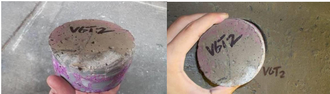
Fig.#59 Aplicación de la prueba de carbonatacion
