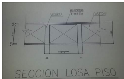
Fig.#49 Fotografía Sección losa tipo.
