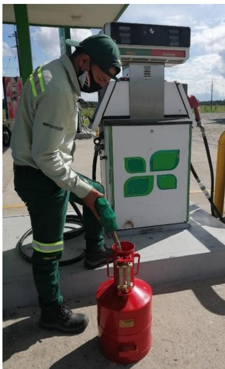
Figura 4. Muestra calibración surtidora con el serafín.
