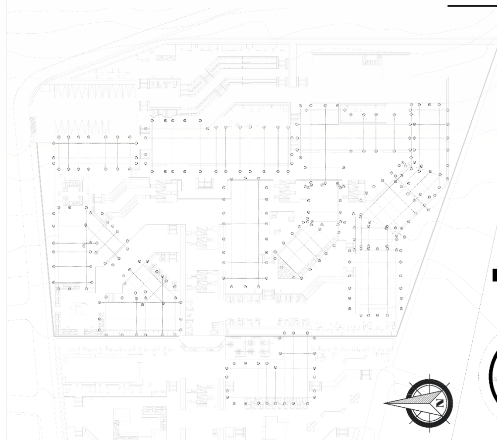
PLACA DE ENTREPISO SISTEMA DE PORTICOS CON PLACA A CASETON DE 0,35
