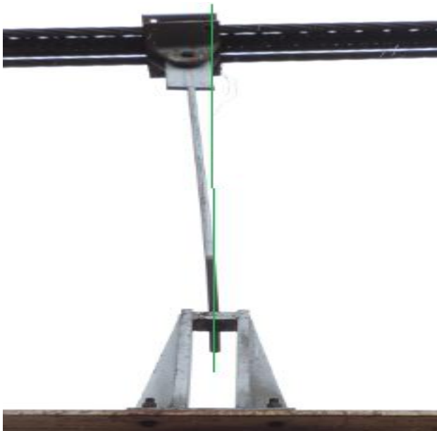
Figura 41. Pendolón deflectado. Fuente propia
