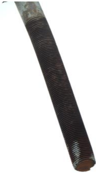
Figura 40. Pendolón fracturado. Fuente Propia
