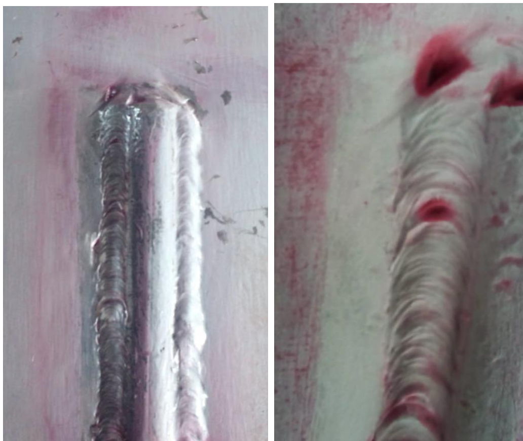
Figura 49. Limpieza y aplicación del líquido revelador
