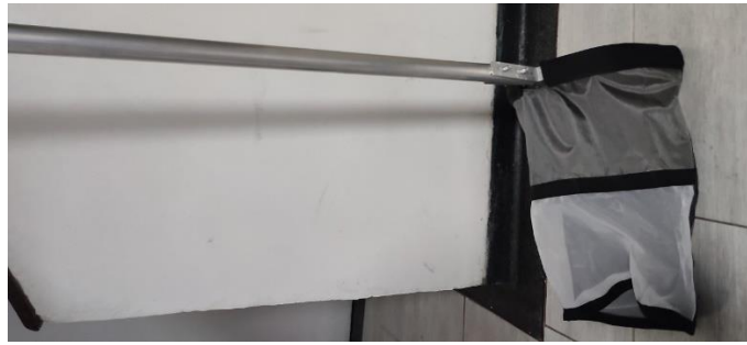
Figura 2 Red tipo D para muestreos de macroinvertebrados acuáticos
