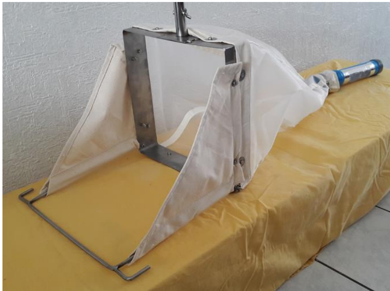
Figura 4 RED SURBER para recolección de macroinvertebrados (Redes Nagut, 2016)
