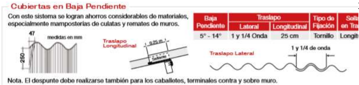
Figura 20. Cubiertas de baja pendiente.
