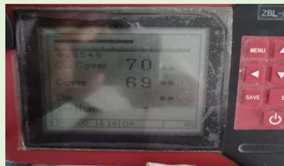
ANÁLISIS CON FERROSCAN
