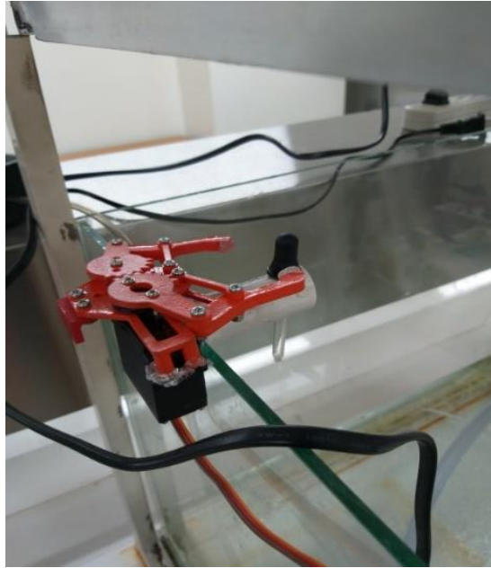
Figura 44. Pinza y Gotero como actuadores del control de pH.
