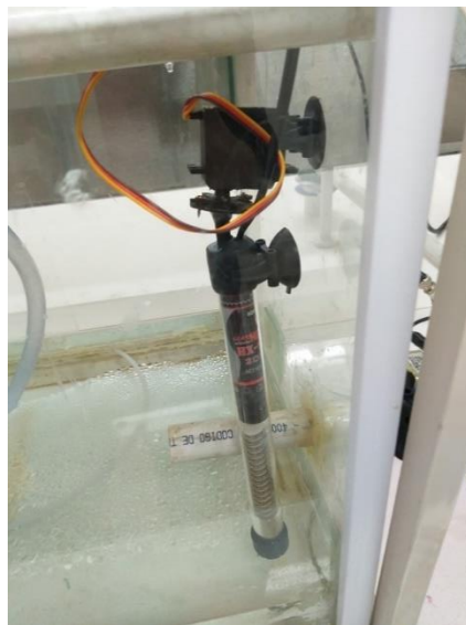
Figura 30. Termostato como actuador del control de temperatura.
