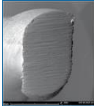
Figura 5. Sección transversal Limas Rotate VDW®
