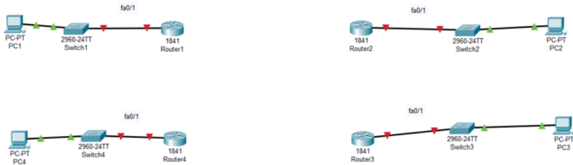
Figura 3.2: Diagrama de conexión Router con LAN.
