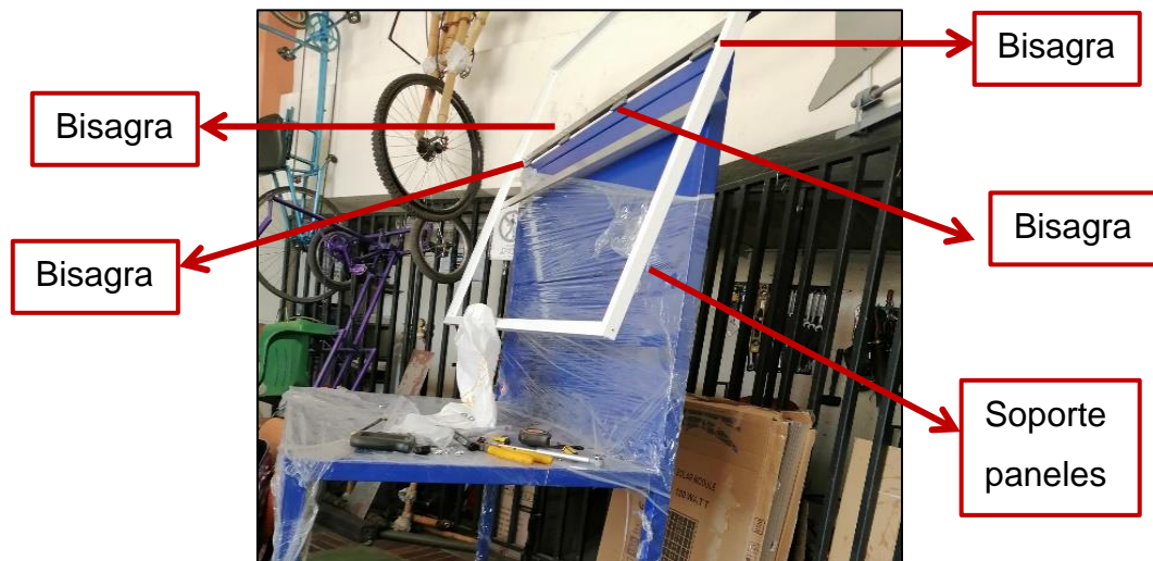
Figura 49. Ensamble de soporte de paneles y estructura.
