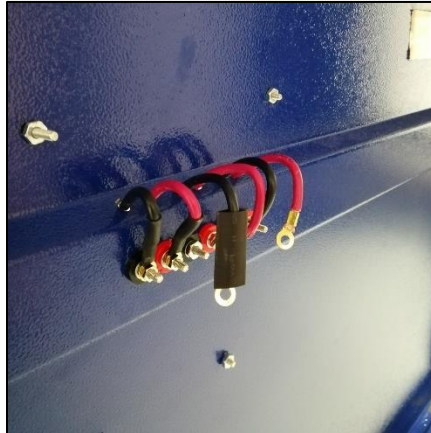
Figura 58. Conexión de entradas de regulador con bananas
