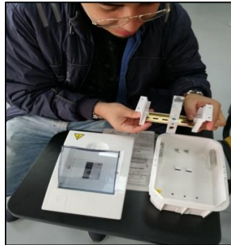
Figura 60. Ensamble de la caja de protecciones.
