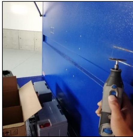
Figura 55. Cortes con Motortool para ensamble de multímetros digitales.
