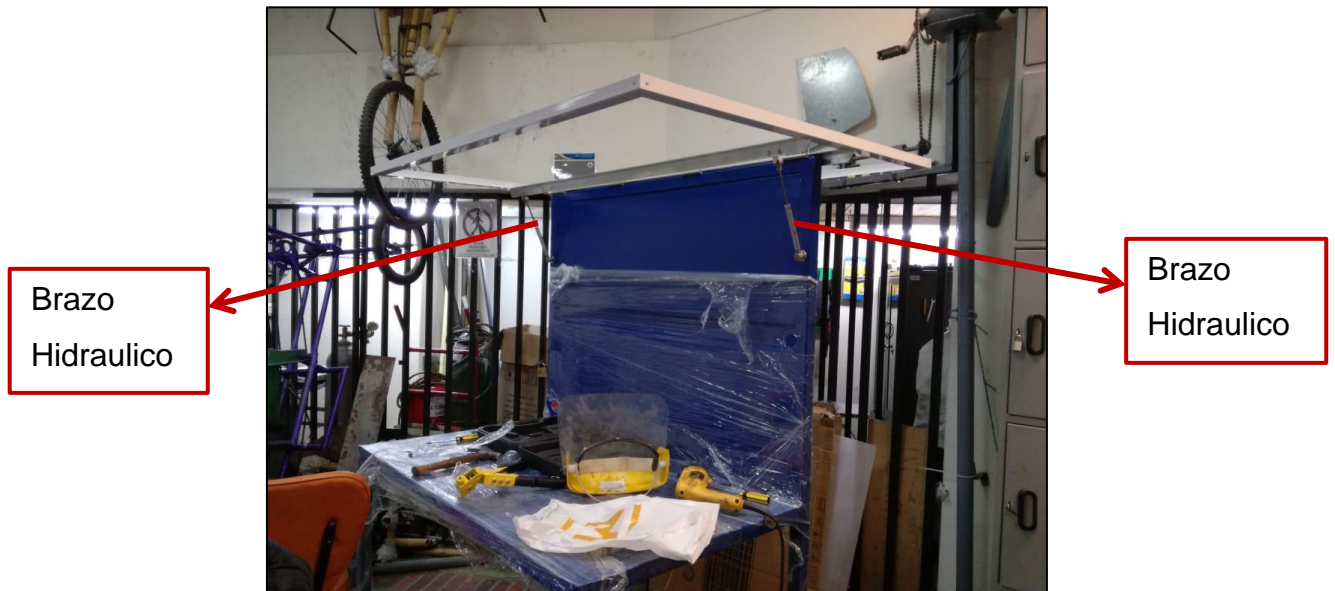
Figura 51. Sistema de brazos hidráulicos.
