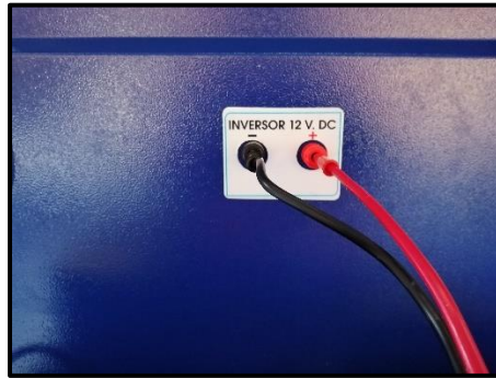
Figura 74. Conexión de inversor a salida CC.
