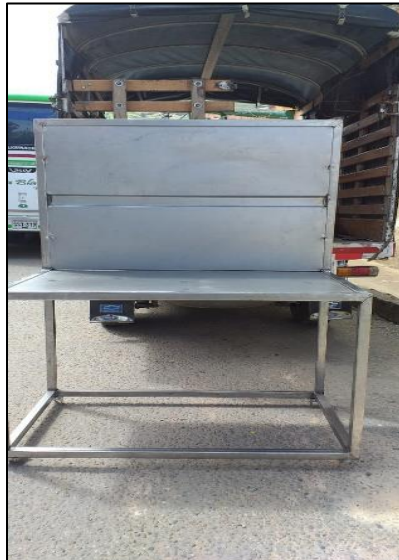
Figura 43. Estructura del banco solar fotovoltaico.
