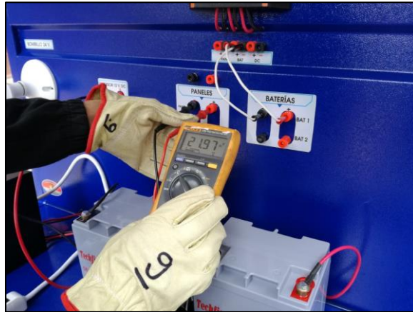
Figura 67. Validación del voltaje pico de los paneles.
