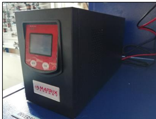
Figura 14. Ilustración del inversor seleccionado.
