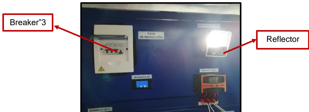
Figura 80. Encendido de reflector alimentado con corriente alterna de salida del inversor.
