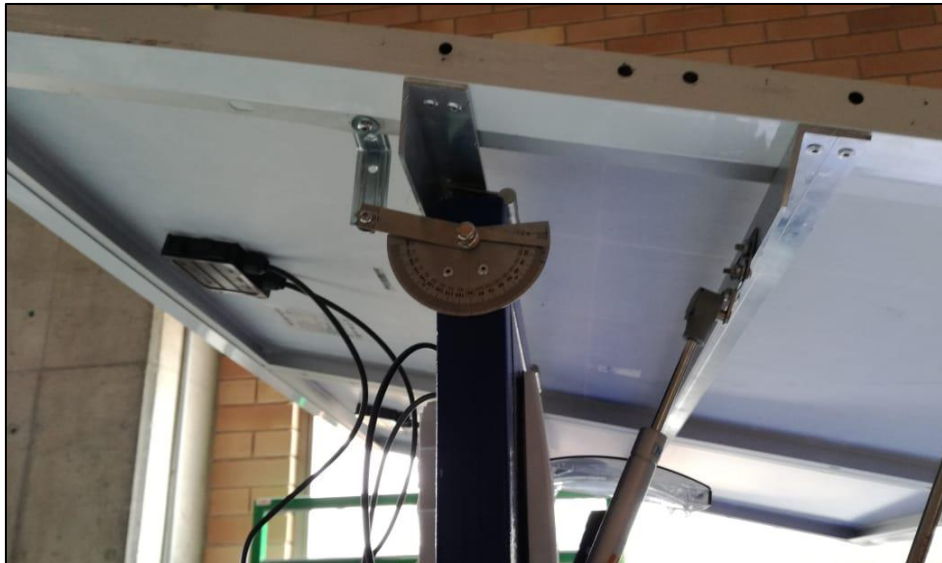
Figura 40. Guía de inclinación con agujeros taladrados
