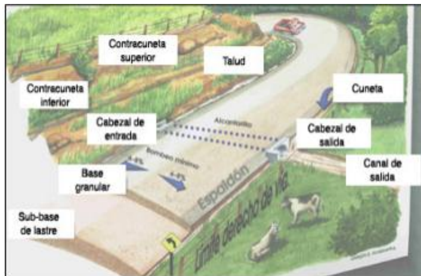
Imagen 10. Sistemas de drenaje de una vía.
