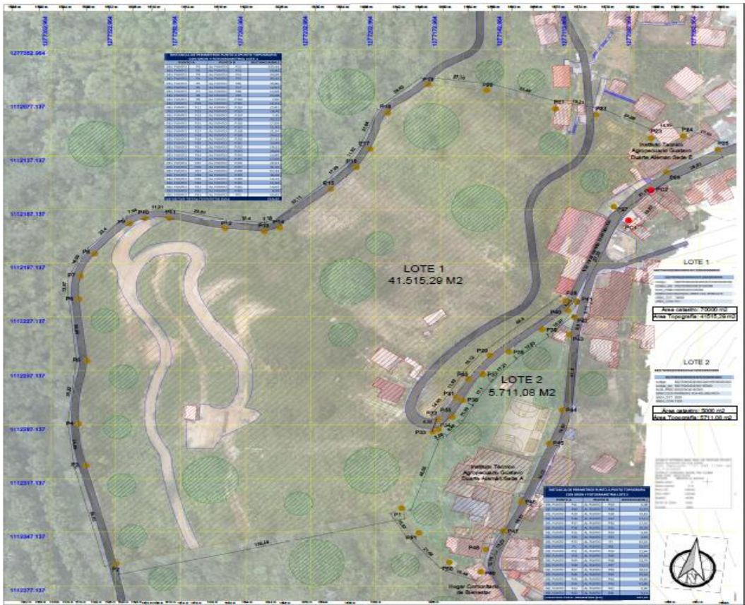
Figura 80. Plano obtenido del levantamiento con Dron.
