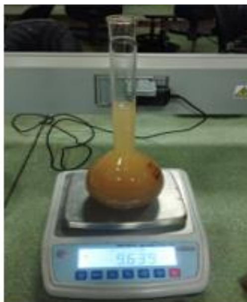
Figura 7. Muestra de arena sumergida en agua para la determinación de la densidad aparente y la absorción.
