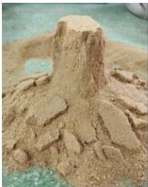
Figura 7. Muestra de arena sumergida en agua para la determinación de la densidad aparente y la absorción.
