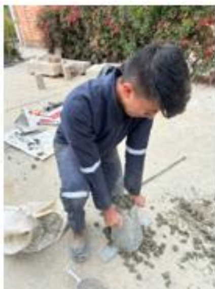
Figura 10. Prueba de asentamiento del concreto (SLUMP).
