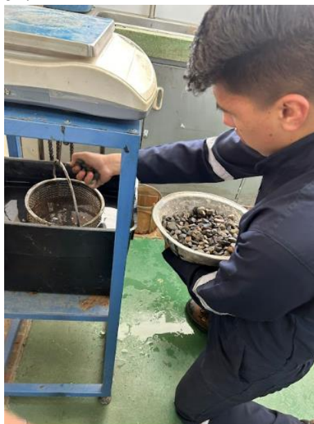
Figura 8. Muestra de escoria sumergida en agua para la determinación de la densidad, la densidad aparente y la absorción.
