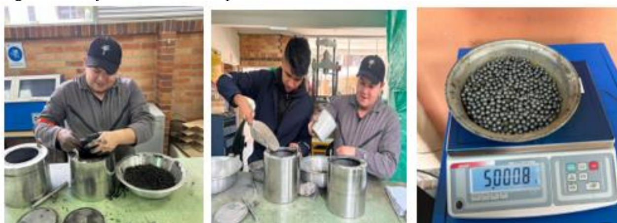
Figura 9. Ensayo con micro-Deval para determinar la resistencia de la escoria
