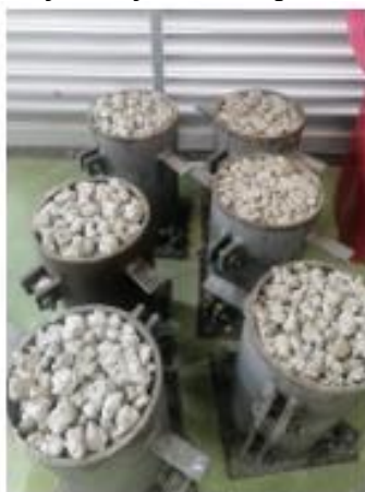
Figura 11. Elaboración de cilindros y ensayo de compresión.
