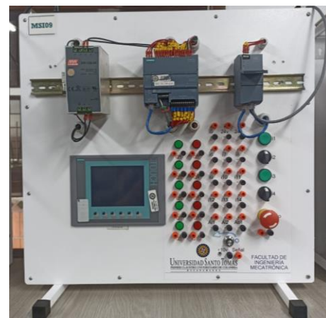
Figura 2. Bancos de trabajo donde están instalados los PLCs siemens S7-1200.
