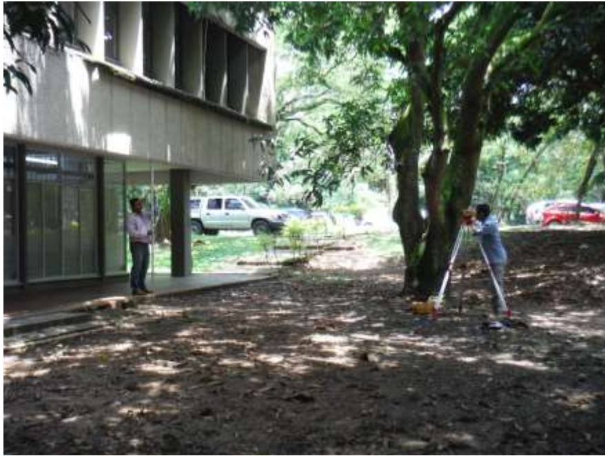
Imagen 35 Levantamiento altimétrico de fachada
