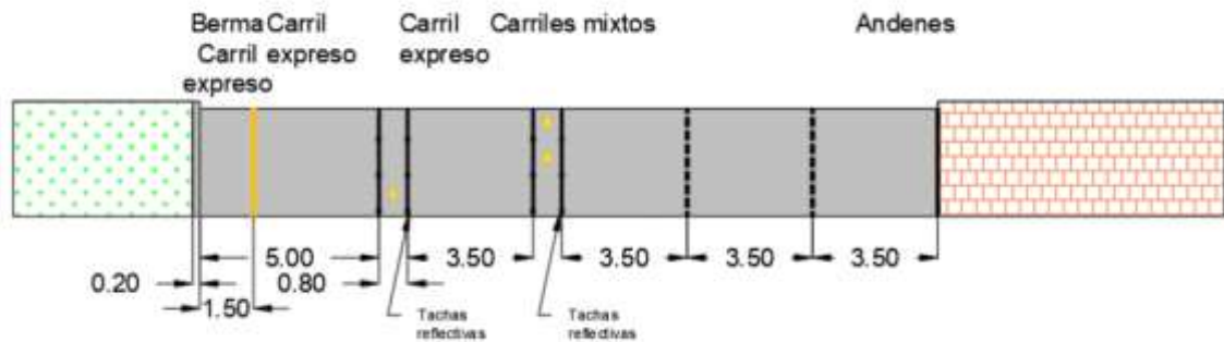
Ilustración 17. Sección Carril Expreso Dos Carriles
