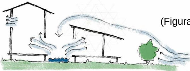
Diagrama de comportamiento de ventilación. Fuente: Arch. Anna Zanetti
