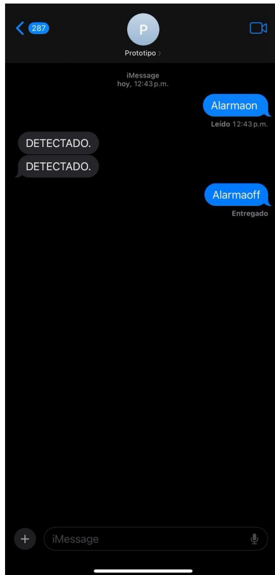
Ilustración 54. Envío SMS comandos Alarmaon y Alarmaoff.
