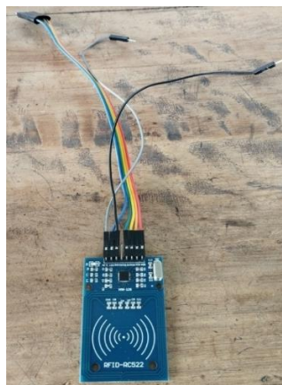
Ilustración 28. Módulo RFID, conexiones de voltaje y datos.
