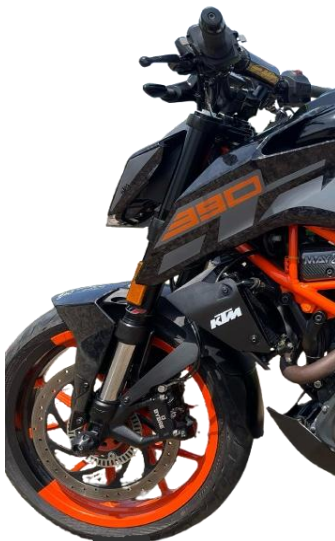
Ilustración 9. Vista sistema de frenado y amortiguación.
