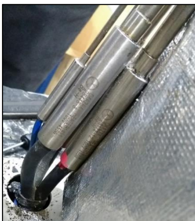
Figura 86. Resistencias eléctricas del reactor.
