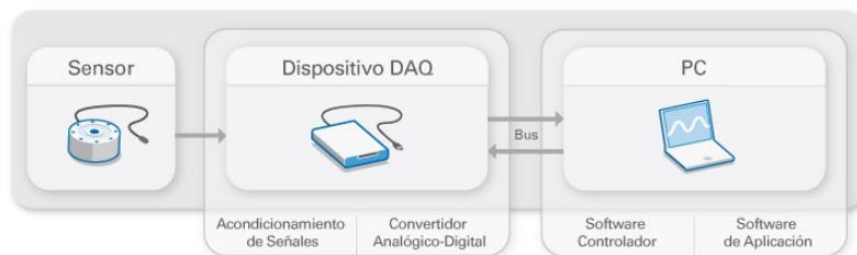
Figura 3. Partes de un sistema DAQ.
