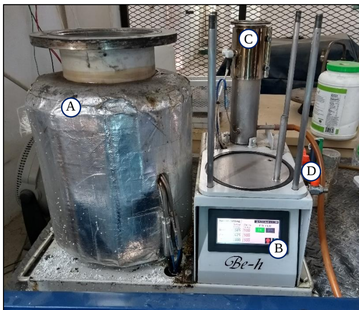
Figura 11. Vista frontal pirolizador en estado de reposo para limpieza.
