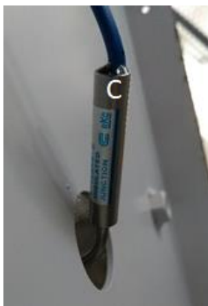
Figura 22. Termocupla parte baja del reactor.
