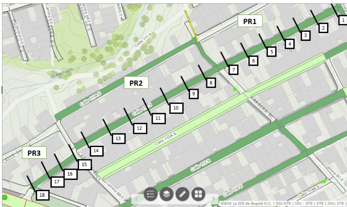
Imagen 31 Localización toma de deflexiones Pavimentos reciclados Fuente: Autor.
