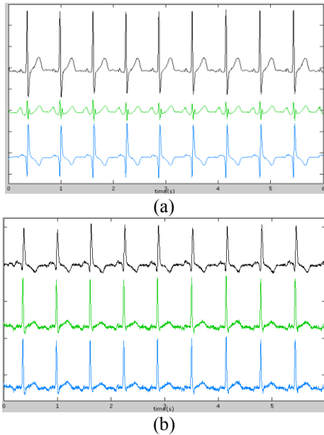
Figura 1. fECG real y observado. (a) fECG real. (b) fECG observado con el algoritmo jadeOP. La SIR es de -20 dB y la SNR de 20 dB (ruido blanco Gaussiano).
