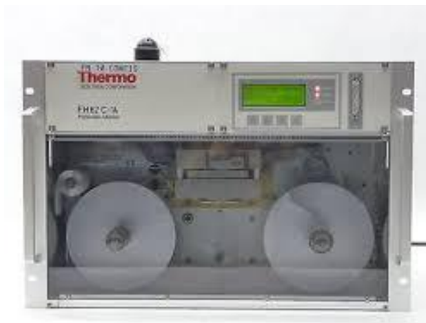
Fig. #8: Monitor de partículas Thermo FH62C-14.
