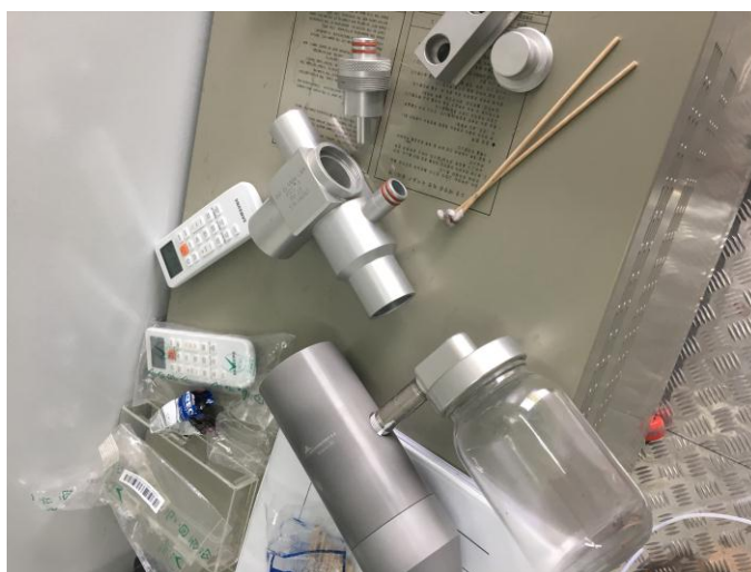
Fig. #14: Cabezal PM10 y Ciclón PM2.5 para equipos de material particulado.
