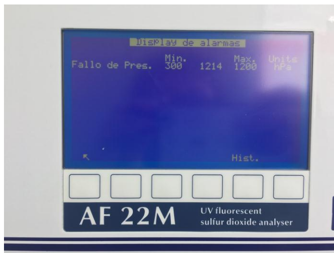
Fig. #4: Alarma equipo SO_2 Bomberos.
