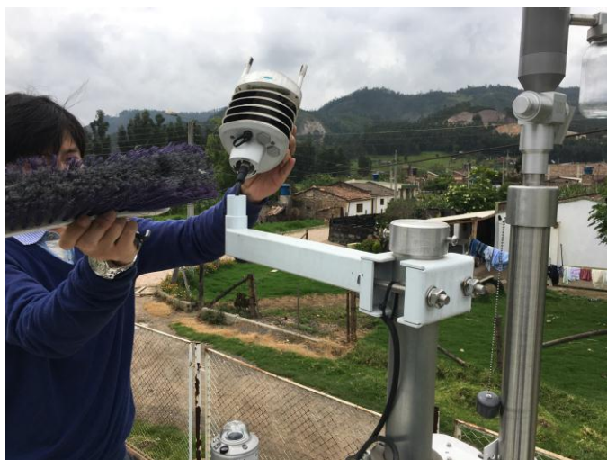
Fig#4: Limpieza sensor meteorológico.
