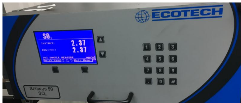
Fig. #10: Analizador de Dióxido de Azufre Serinus 50.
