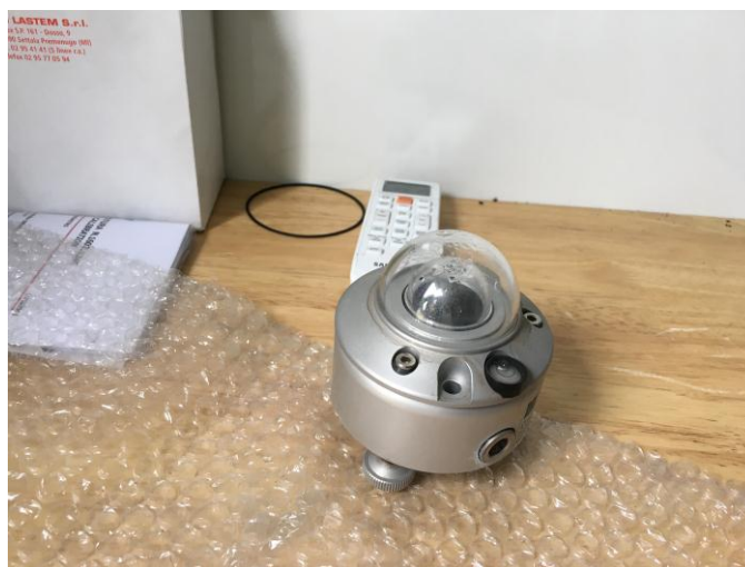
Fig#2: Sensor de radiación con filtración de agua.
