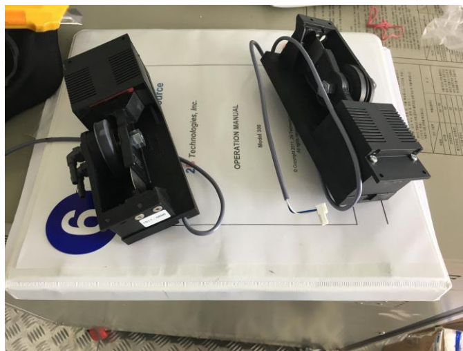
Fig#5: Bombas internas equipo SO 2 .
