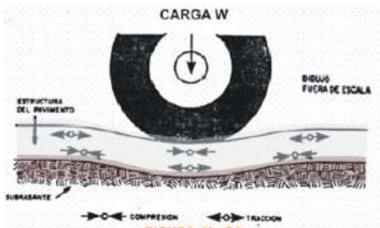
Ilustración 7 - Esfuerzos de tracción y compresión sobre un pavimento flexible. Fuente: Sánchez Sabogal (1992)
