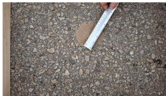
Ilustración 21. Registro fotográfico ensayo del cono de arena
