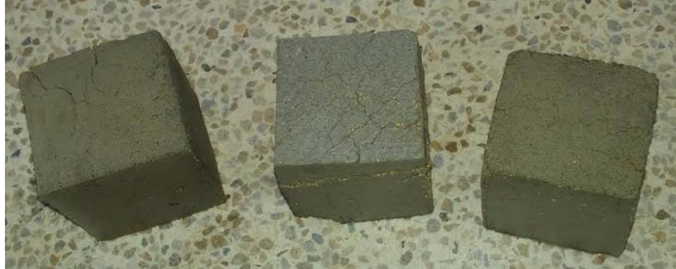
Figura 19. Cubos de mortero de cemento hidráulico antes de ser fallados (ensayo 2).
