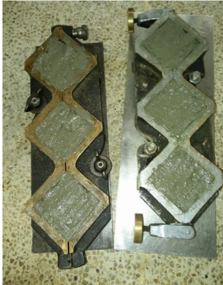
Figura 10. Moldes de mortero de cemento hidráulico convencional compactados
