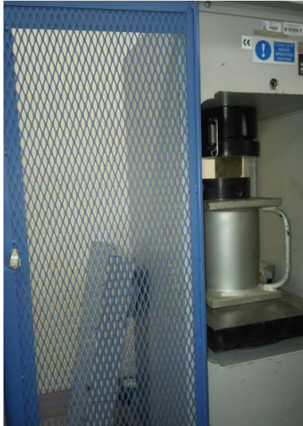
Figura 16. Ensayo de resistencia a la compresión (laboratorio USTA).
