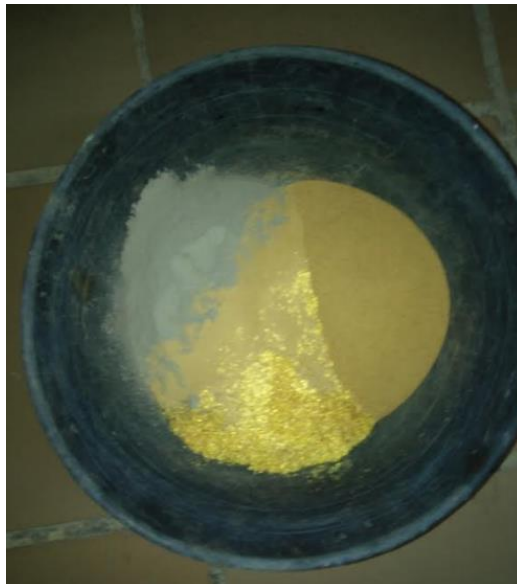
Figura 7. Dosificación de mezclas de mortero de cemento hidráulico
