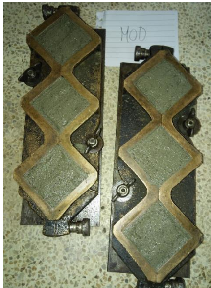
Figura 9. Moldes de mortero de cemento hidráulico modificado compactados
