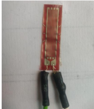
Figura 140. Galga extensométricas con cables soldados
