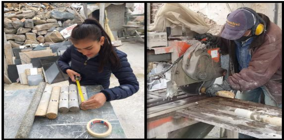
Figura 28. Marcación y delimitación de las probetas para el corte
