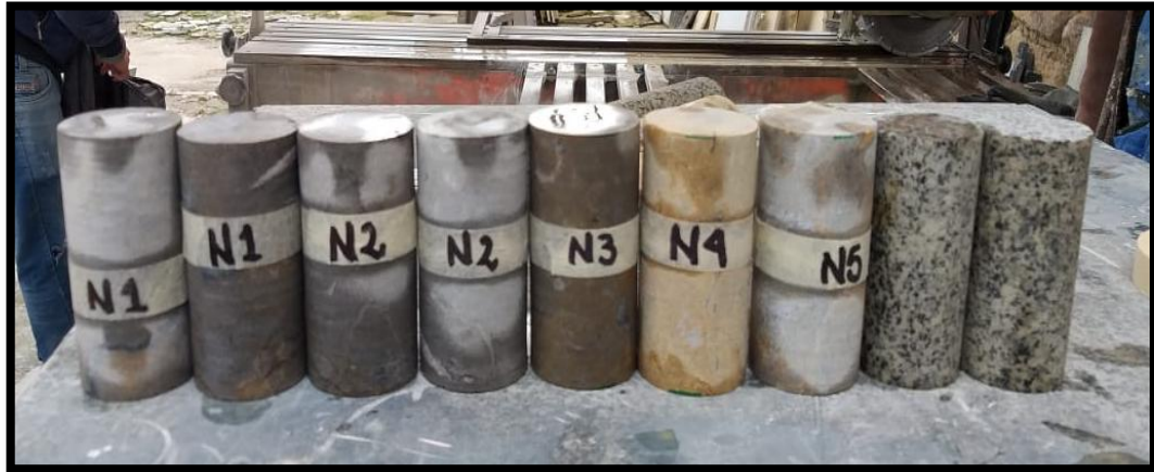
Figura 29. Muestras de núcleos de roca adecuadas
