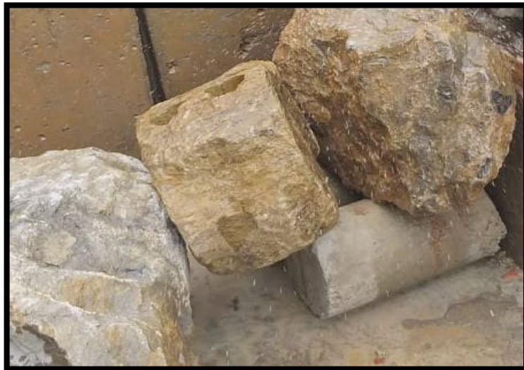
Figura 24. Bloques acomodados para extracción de los núcleos.
