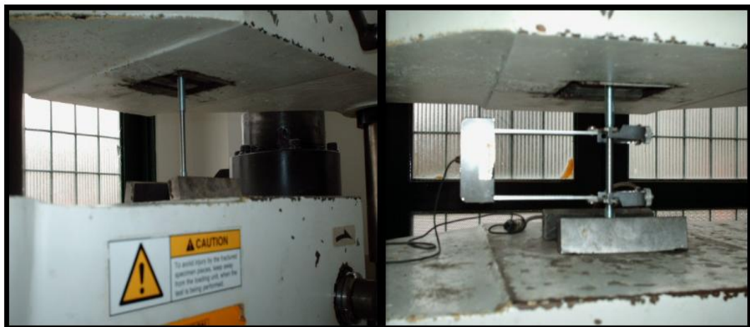
Figura 21. Colocación de la barra en la maquina universal y del extensómetro.
