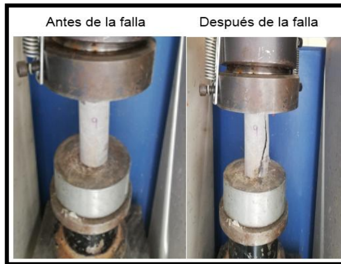
Figura 6. Probeta sometida a ensayo de compresión simple
