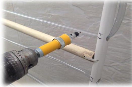
Ilustración 8: Perforación de la manguera de 3/8"
