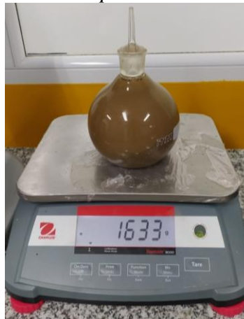
Figura 13. Pesaje de picnómetro a su máxima capacidad
