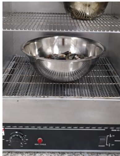
Figura 20. Muestra ingresada para secado al horno
