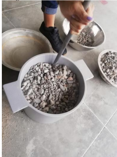
Figura 34. Apisonamiento del agregado grueso
