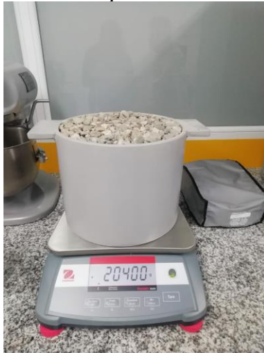
Figura 35. Masa del agregado grueso con el recipiente
