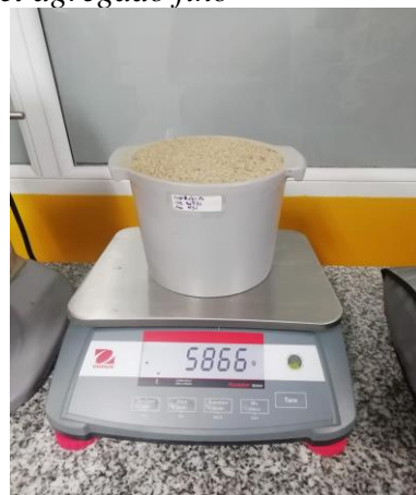
Figura 33. Masa del recipiente con el agregado fino
