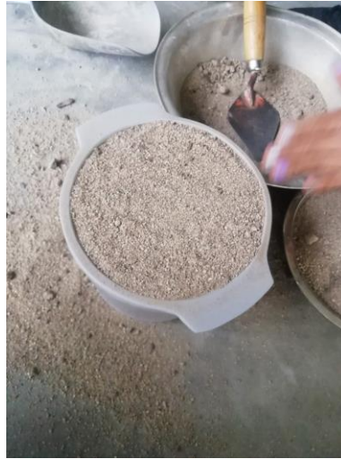
Figura 32. Enrase de la superficie del material
