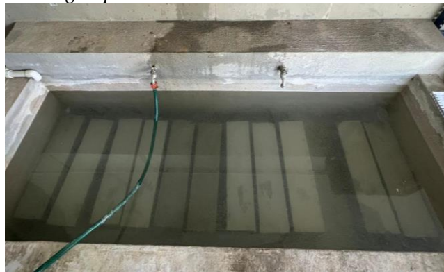
Figura 40. Vigas sumergidas en agua para curado
