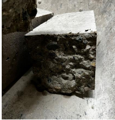
Figura 45. Probeta después de ensayo NTC 2871.
