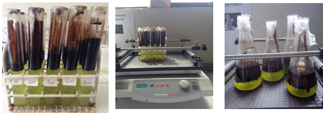
Figura 20. Adaptación de la microalga a volúmenes crecientes de petróleo.
