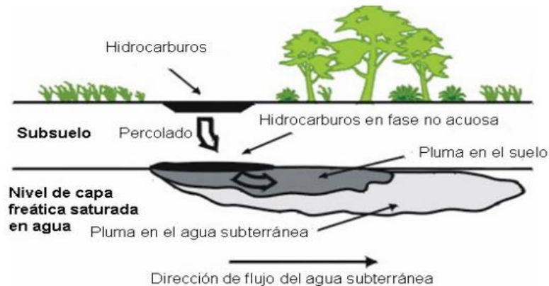
Figura 5. Efectos de los derrames de hidrocarburos de petróleo en suelos 29 .
