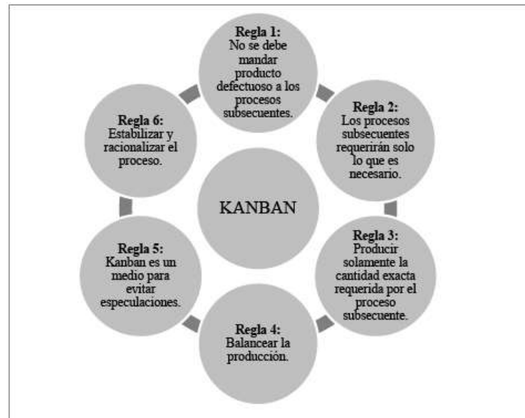
Figura 4. Gráfica de las reglas del Kanban, artículo Mejoramiento de procesos de manufactura utilizando Kanban (Martin Darío Arango Serna, 2015, p. 225)
