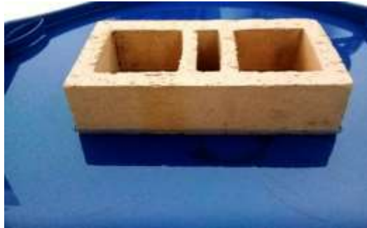
Figura 25. Sumergimiento parcial de Ladrillo tipo arena PV para eflorescencia
