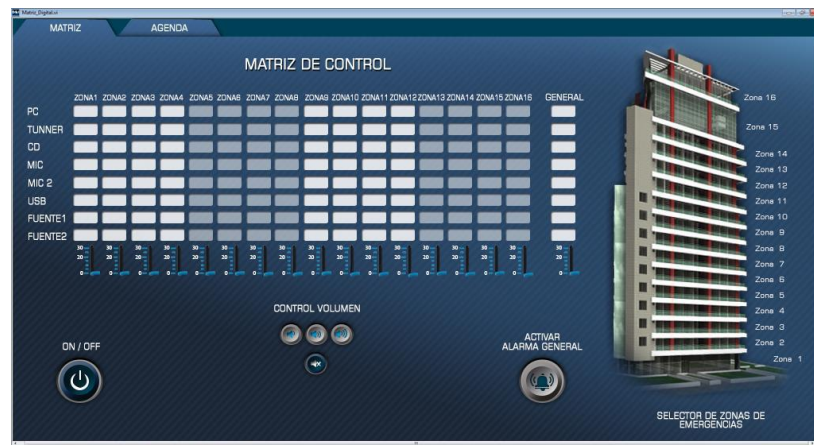
Ilustración 15 Matriz de control del sistema de sonido
