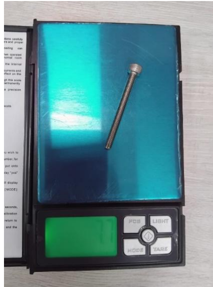
Figura 6-20. Instalación y pesaje masa de desbalance.
