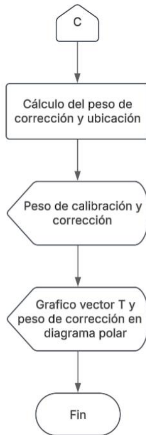
Figura 6-55. Diagrama de flujo módulo de balanceo parte C.
