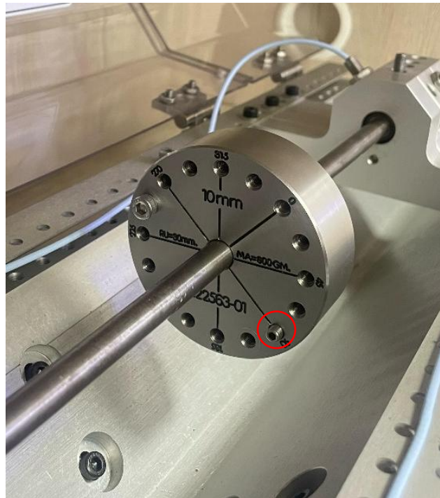
Figura 6-30. Retiro del peso prueba e instalación del peso de corrección.
