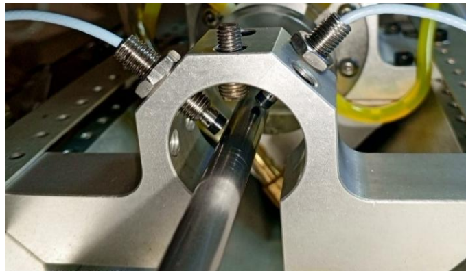
Figura 6-17. Probetas de proximidad rotor kit
