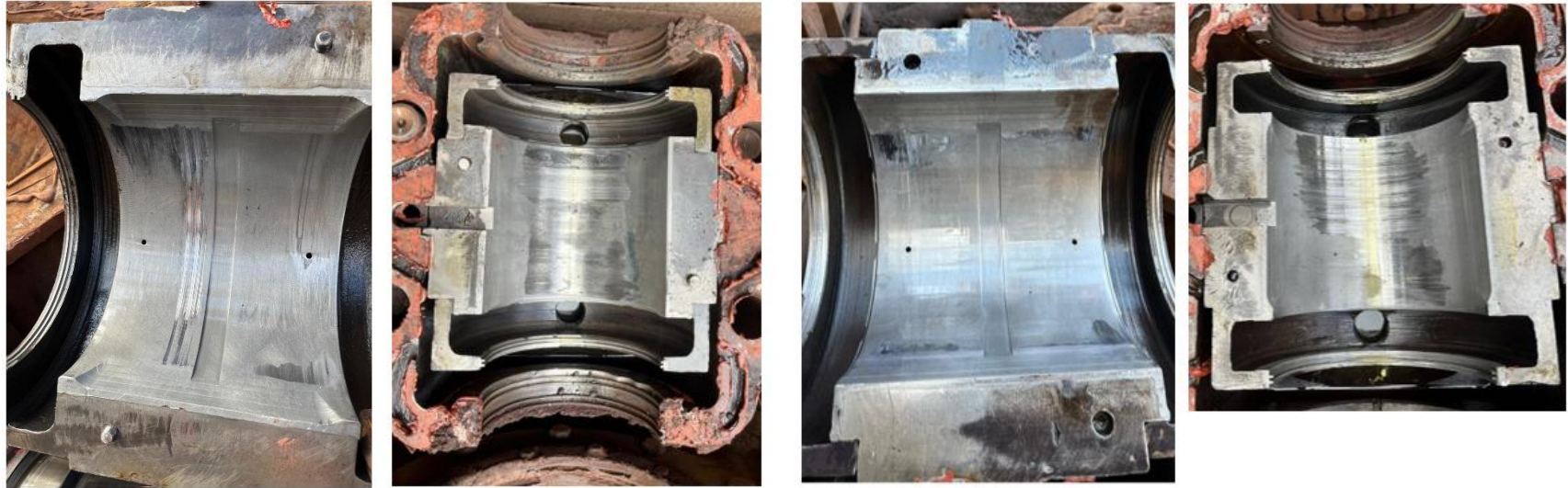
Figura 6-94. Estado cambio de cojinetes CON implementación de monitoreo y software balanceo.
