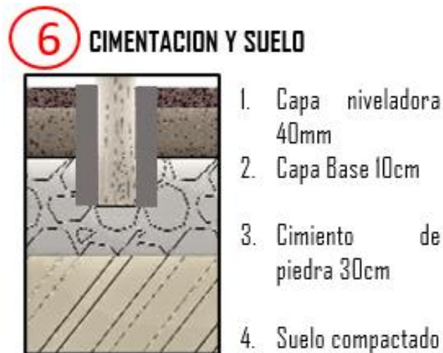
Figura 58. Detalle cimentación y suelo
