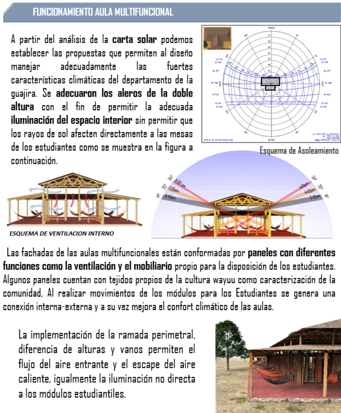
Figura 44. Manejo asoleamiento y ventilación aula multifuncional
