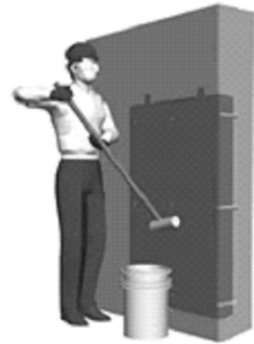
Figura 58 Procedimiento de tratamiento: curado y acabados (Emmons, 2012)
