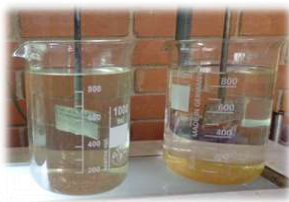
Ilustración 14. Jarras con sulfato de aluminio y cloruro férrico
