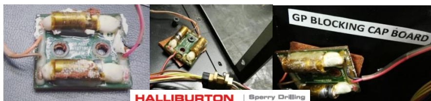
Figura 52. Capacitores de protección.
