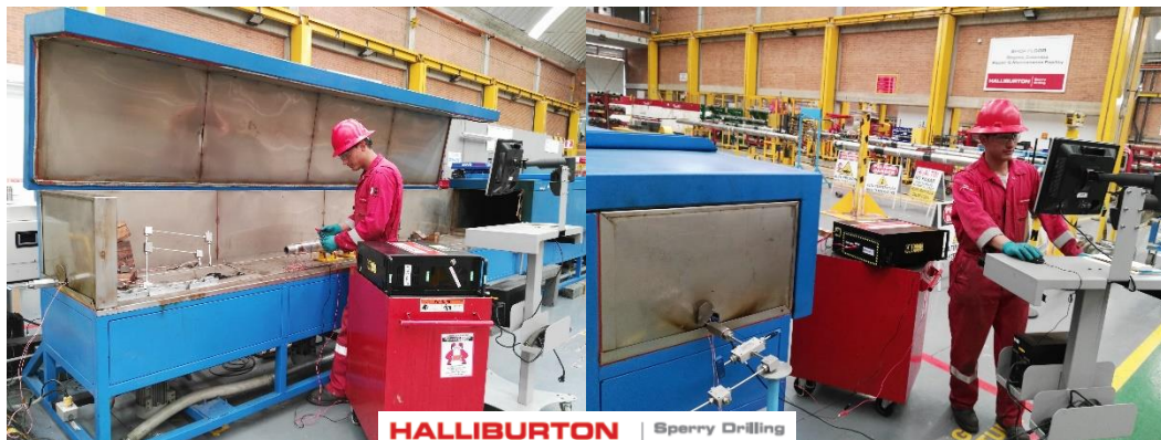
Figura 84. Prueba con Repeater en horno
