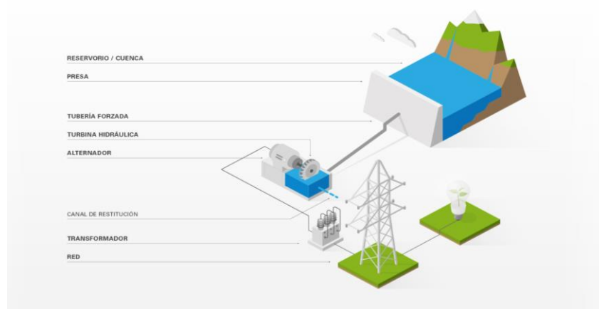
Figura 4. Esquema de una central hidroeléctrica
