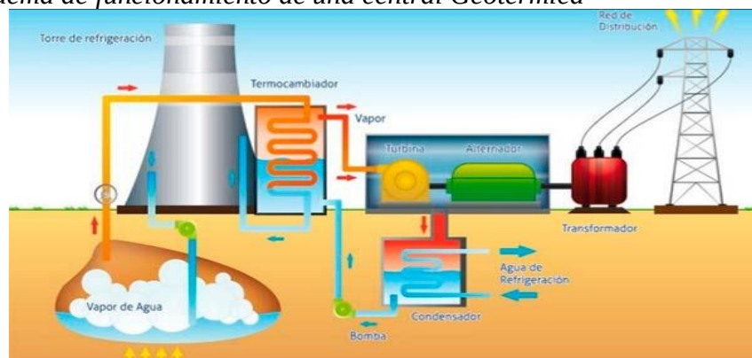
Figura 5. Esquema de funcionamiento de una central Geotérmica
