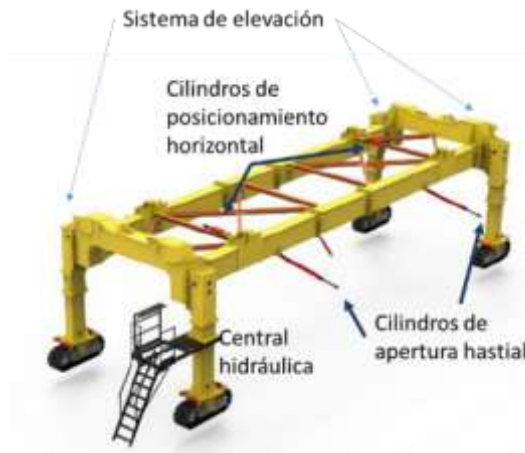
Figura 22. Carro porta encofrado.
