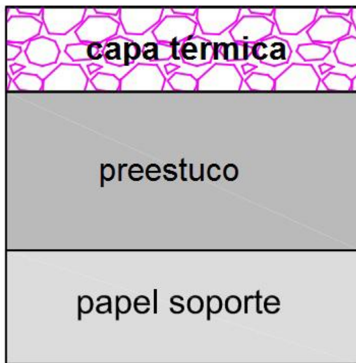
Figura 1. Capas del papel térmico [8]
