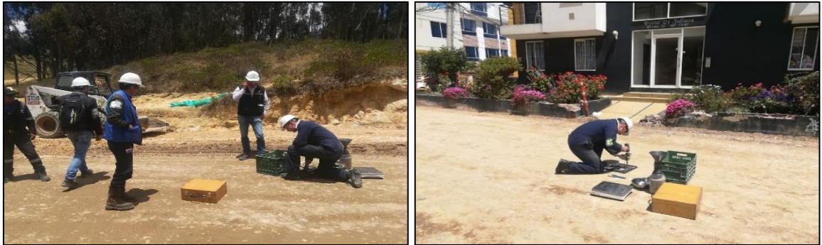
Ilustración 14: Ensayo cono y arena Palos Verdes.
