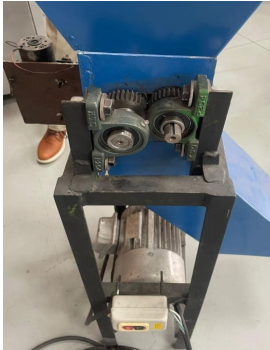
Figura 4. Deficiencias en la máquina trituradora de la facultad de ingeniería mecánica
