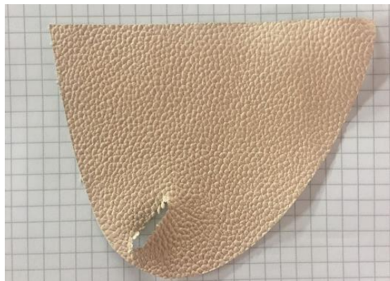
Figura 4. Ejemplo de daño en pieza por falta de filo de la máquina
