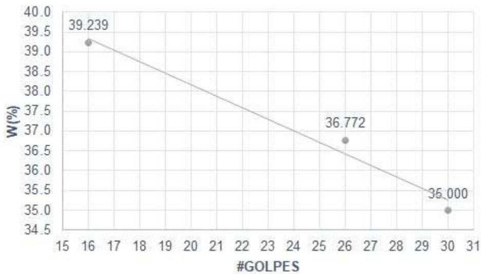
Figura 8-6 Curva de fluidez en estado natural Fuente: Autores
