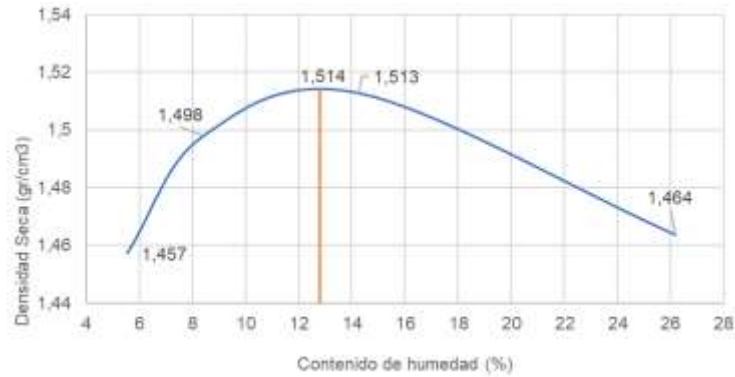
Figura 9-12 Proctor modificado estabilizado con cal Fuente: Autores.
