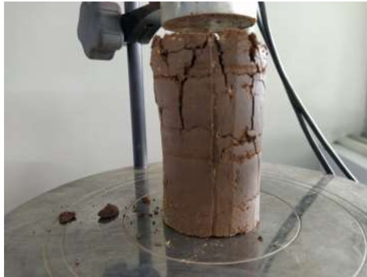
Figura 8-11 Ensayo Compresión Inconfiada Fuente: Autores
