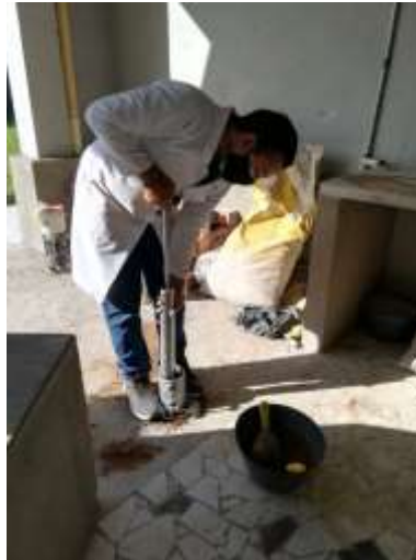
Figura 9-9 Procedimiento ensayo Proctor modificado Fuente: Autores
