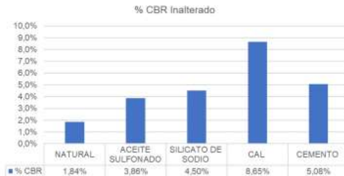
Figura 9-7 Valore de CBR inalterado para muestras estabilizadas Fuente: Autores
