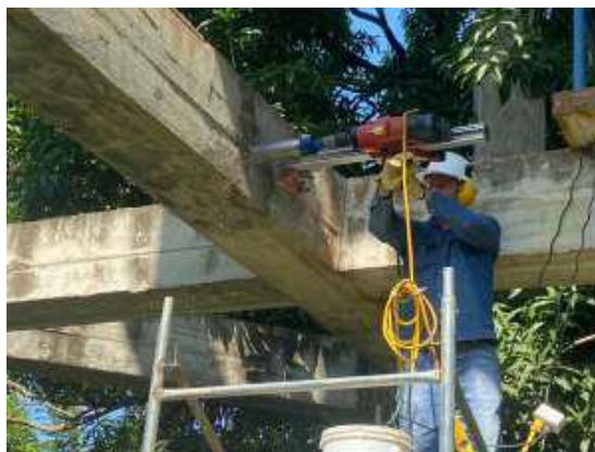
Fotografía 26 — Ensayo de extracción de núcleos
