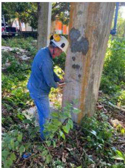
Fotografía 27 — Ensayo de esclerometría
