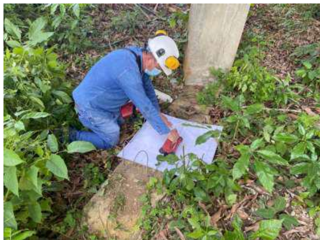
Fotografía 24 — Escáner de refuerzo
