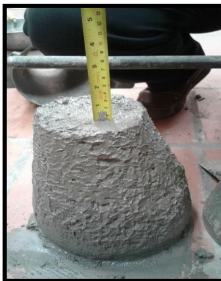
(Img 050) Asentamiento mezcla 1
