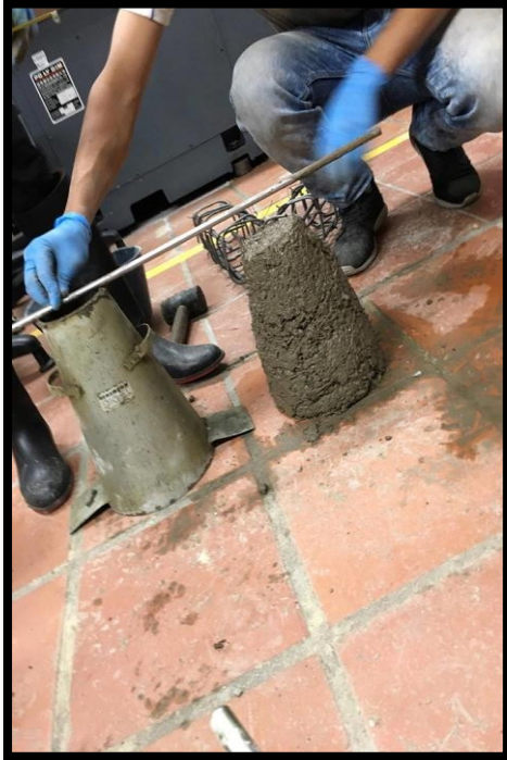
Validación asentamiento de la mezcla
