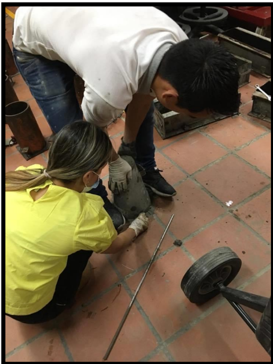
Ensayo de asentamiento
