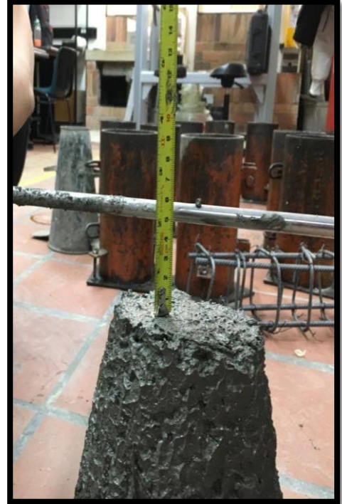
Medición asentamiento de la mezcla
