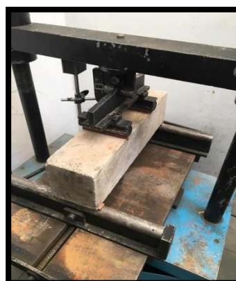
Ensayo viga a flexión
