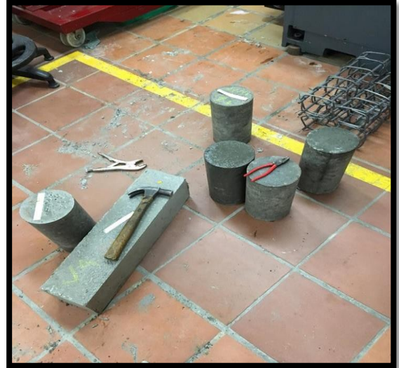
Desencofrado especímenes mezcla 1
